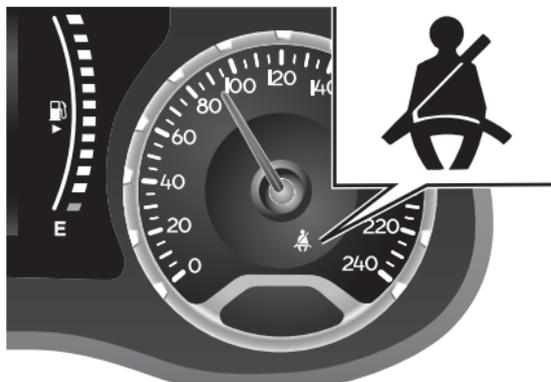
Com o veículo parado, se o cinto de segurança do lado do condutor for desativado ou o cinto de segurança do lado do passageiro estiver desativado (com o passageiro sentado), a luz permanece acesa com luz fixa.
