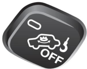
Para interromper a função, pressionar o botão **A** antes da ativação do alarme.
