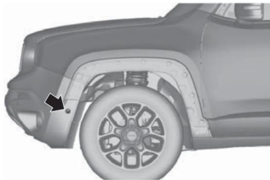
Durante a manobra, e diante da detecção de obstáculos, o condutor também recebe informações oferecidas pelos sensores de estacionamento (4 dianteiros e 4 traseiros) que fornecem informações extras sobre a distância a ser mantida dos obstáculos à frente e atrás do veículo.
