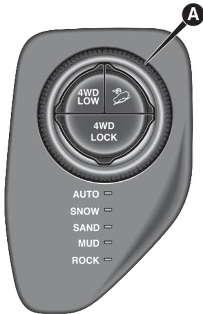
A rotação do manípulo, se a funcionalidade 4WD LOW não tiver sido anteriormente ativada, ativará automaticamente a funcionalidade 4WD LOCK.
