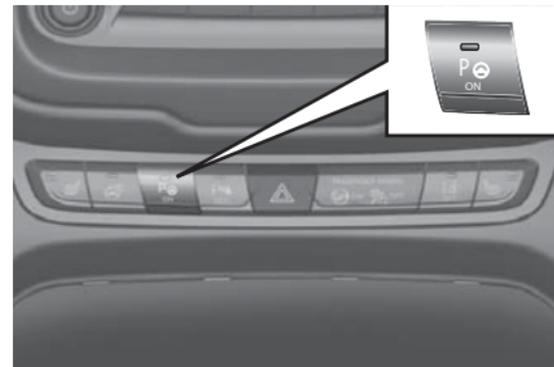
As luzes de LED também se acendem no caso de uma falha no sistema Active ParkSense®. Se a tecla é pressionada durante uma avaria no sistema, o LED pisca por cerca de 5 segundos e depois é desativada.
